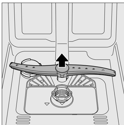
4. Промойте распылительные коромысла в проточной воде.
